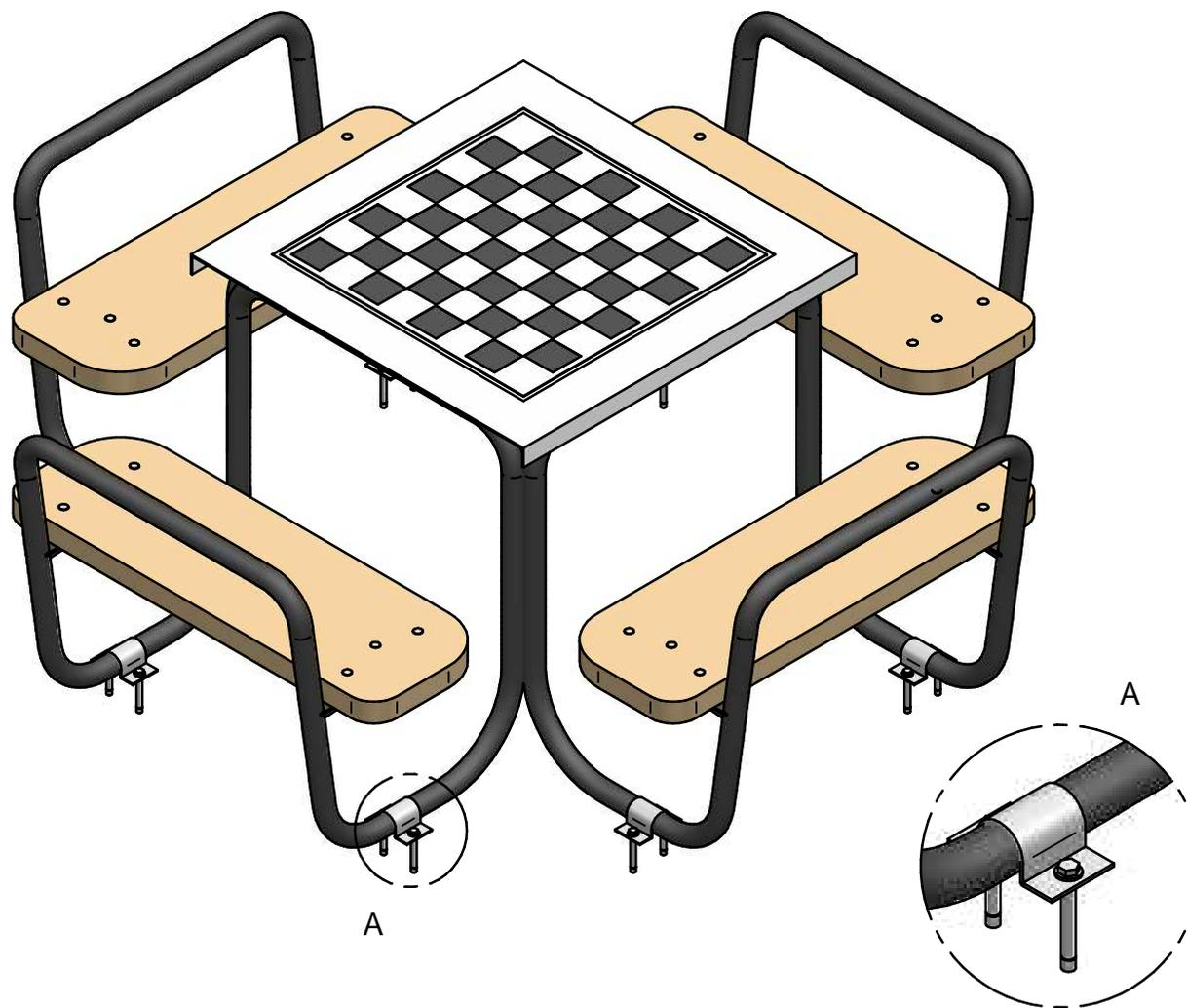
Se coloca la pieza de fijacion con dos tornillos de anclaje.
